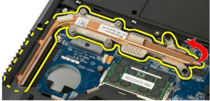
7. החלק את גוף הקירור לעבר מרכז המחשב, הרם אותו והוצא אותו מהמחשב.
